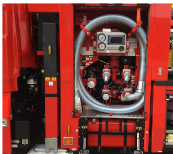
ポンプ室側板
