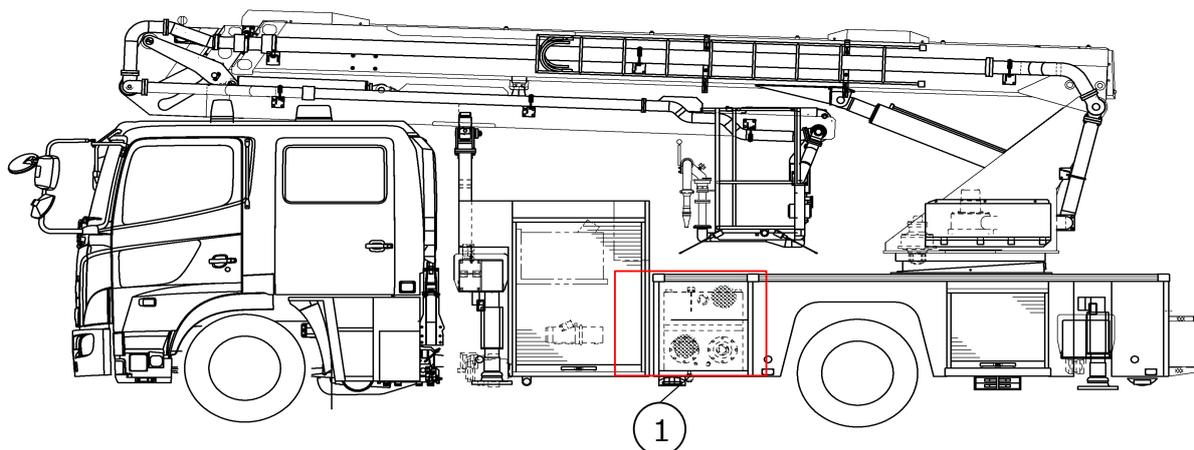
① : オイルタンクに取付けられたドレンバルブを開き、受け皿を用意してオイルタンク内の作動油を排出してだ
