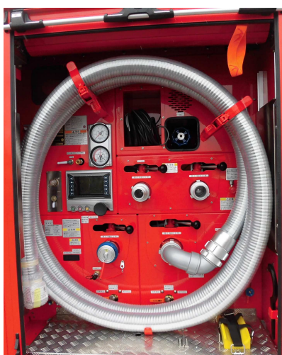
ポンプ室側板
